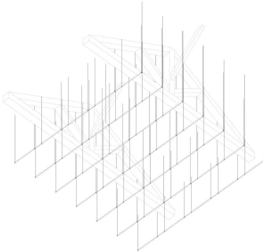
vue isométrie plafonnante - principe d'implantation des luminaires
