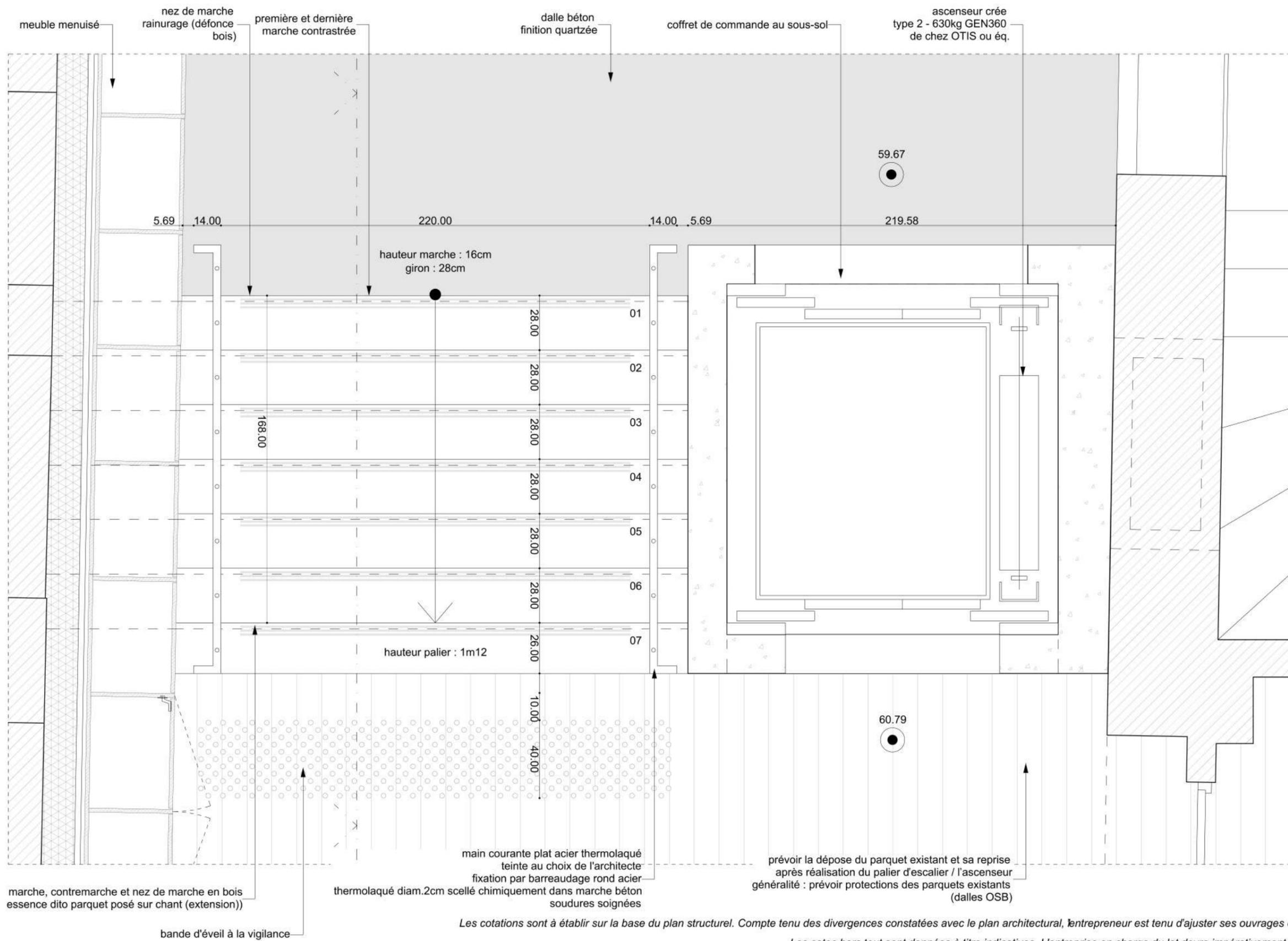
Les cotations sont à établir sur la base du plan structurel. Compte tenu des divergences constatées avec le plan architectural, l'entrepreneur est tenu d'ajuster ses ouvrages conformément au plan structurel. Les cotes hors tout sont données à titre indicatives. L'entreprise en charge du lot devra impérativement prendre toutes les cotes sur site.
