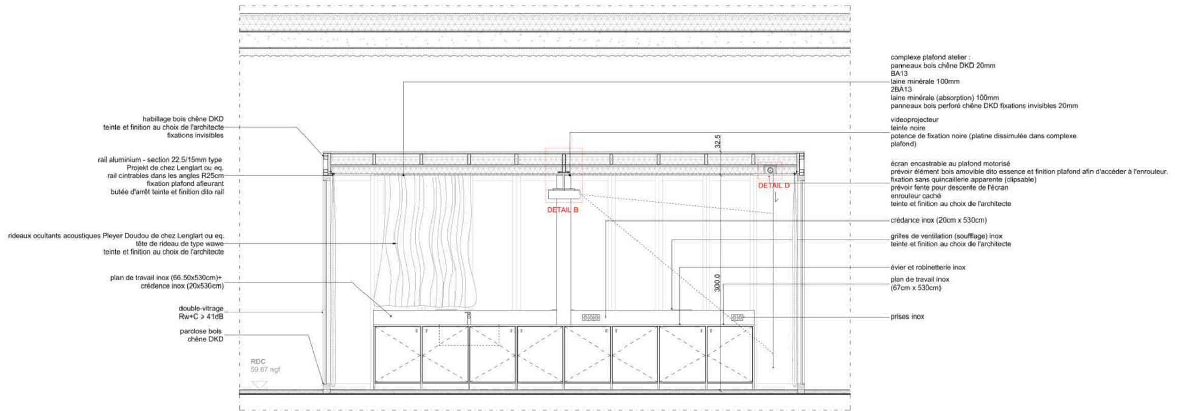
Les cotations sont à établir sur la base du plan structurel. Compte tenu des divergences constatées avec le plan architectural, l'entrepreneur est tenu d'ajuster ses ouvrages conformément au plan structurel
