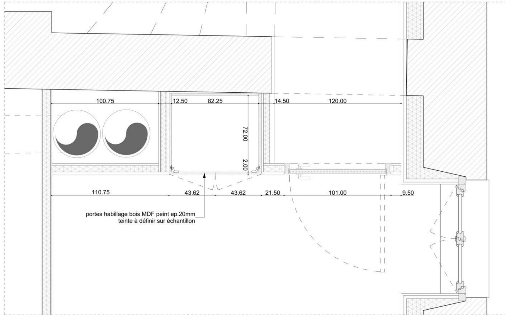
Les cotations sont à établir sur la base du plan structurel. Compte tenu des divergences constatées avec le plan architectural, l'entrepreneur est tenu d'ajuster ses ouvrages conformément au plan structurel
