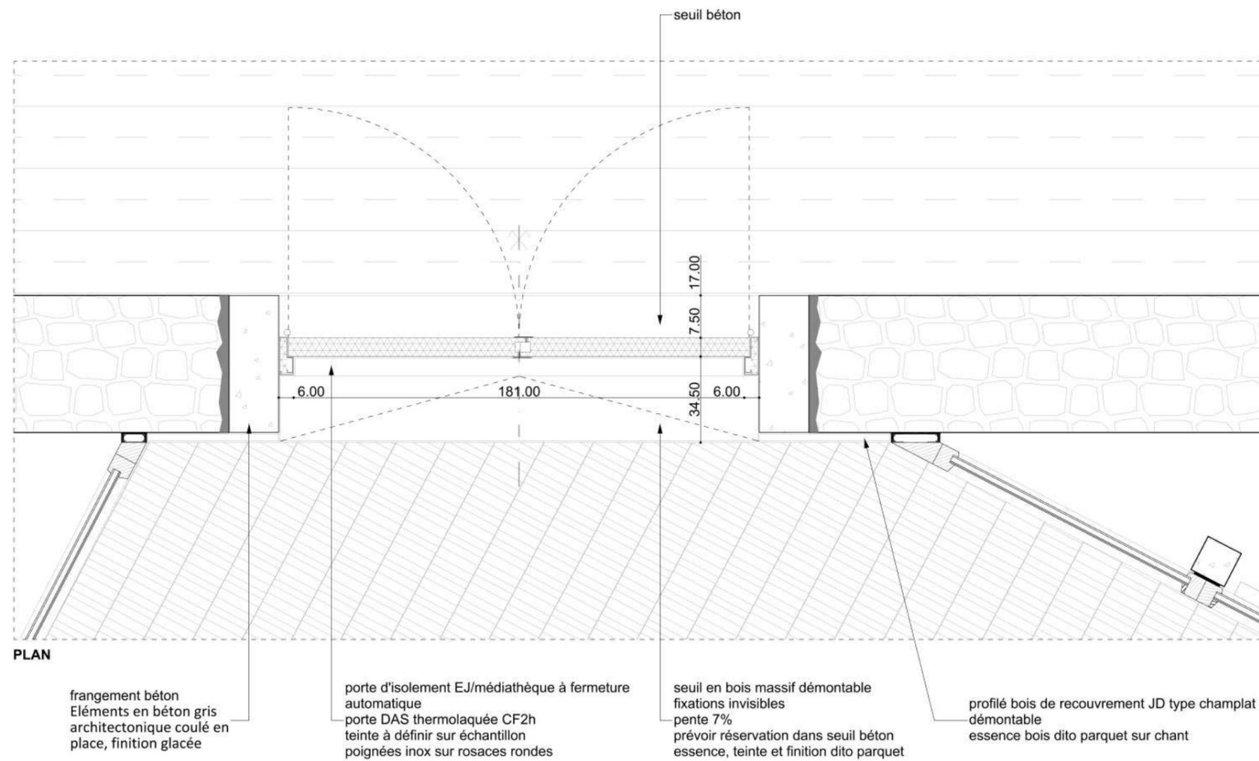
Les cotations sont à établir sur la base du plan structurel. Compte tenu des divergences constatées avec le plan architectural, l'entrepreneur est tenu d'ajuster ses ouvrages conformément au plan structurel.
